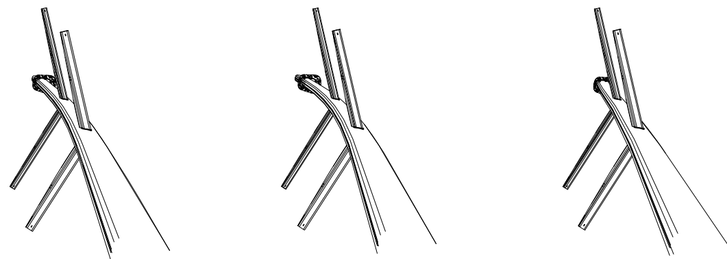
Korrekt placerad mastfot.
