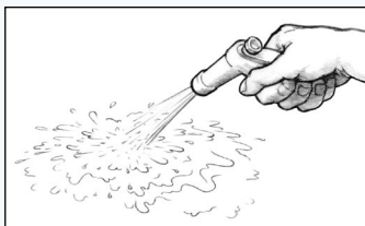
Figur 33 Tvätta ytan med färskvatten efter slipning.
